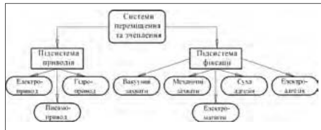
Рис. 2. Структура підсистем утримання й переміщення роботів
